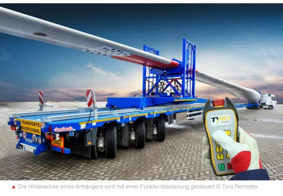
▲ Die Hinterachse eines Anhängers wird mit einer Funkfernbedienung gesteuert © Tyro Remotes
